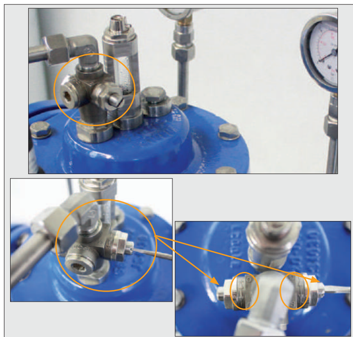
Рис. 26: Настройка скорости открытия и закрытия
