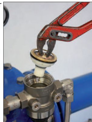
Рис. 45: Снятие внутреннего комплекта
