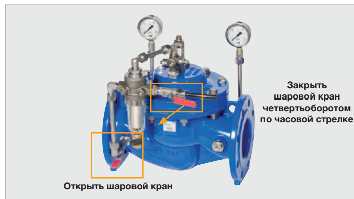
Рис. 24: Открытый и закрытый шаровые краны
