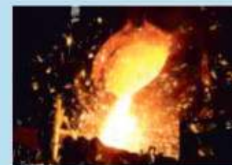
Химическая коррекция жидкого металла в индукционной печи
